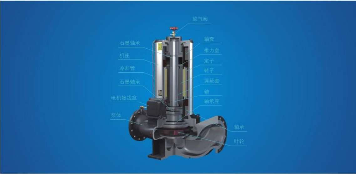
SPG系列静音屏蔽泵主要由：泵体、叶轮、轴、轴套、推力盘、定子、转子、屏蔽套、石墨轴承、轴承座、冷却管、放气阀、机座、电机接线盒等零部件组成。
